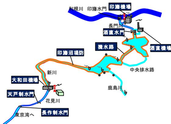
図-1 印旛沼開発施設模式図
